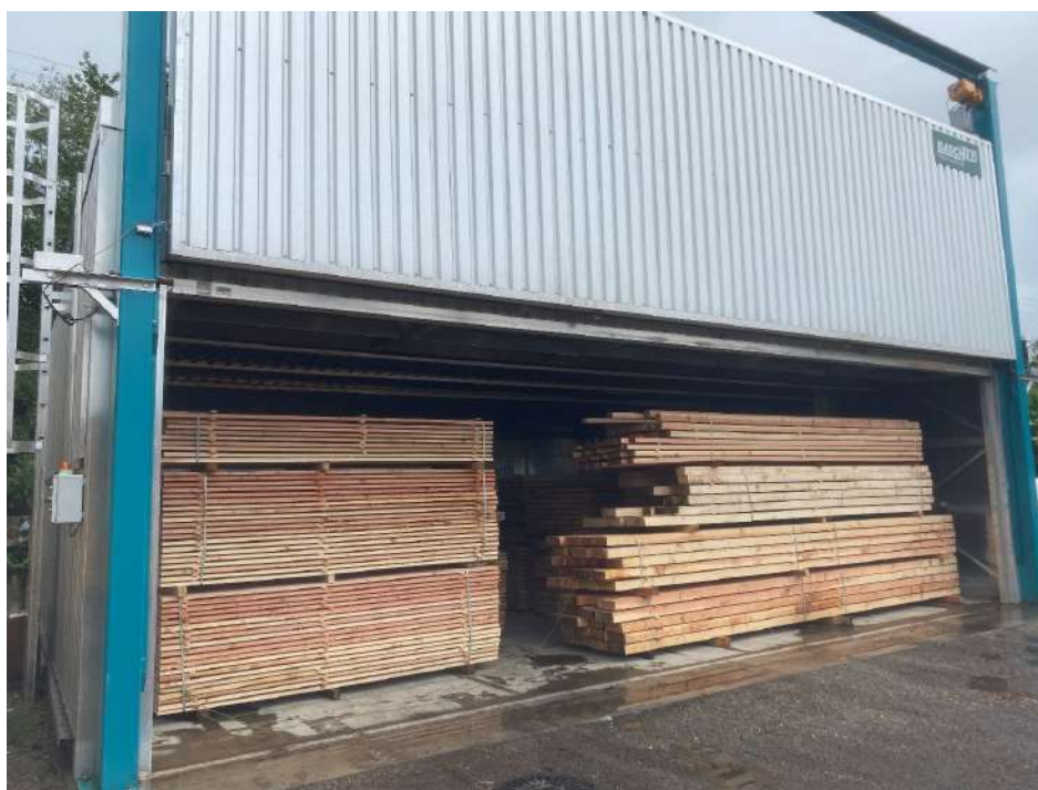
Scierie Armengol – séchage
